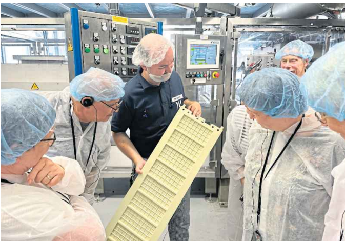
Lebensmitteltechnologe Maximilian Marosch zeigt den NW-Lesern die Formen, in die die flüssige Schokolade gefüllt wird.
