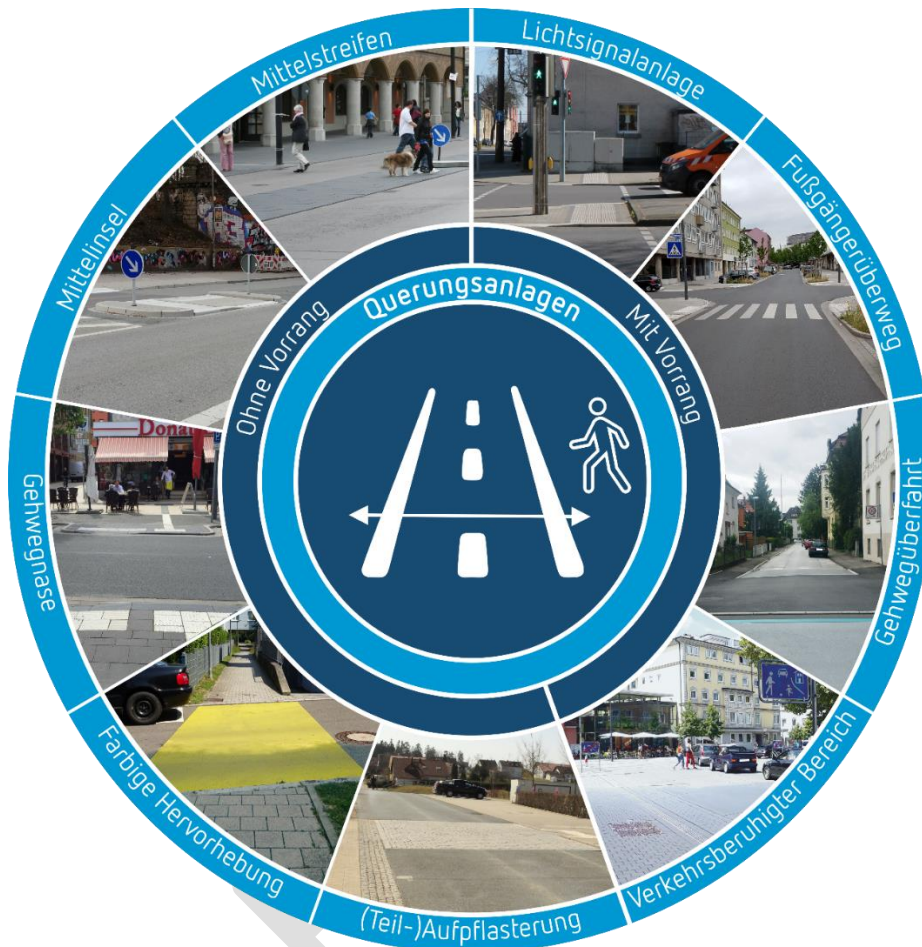
Abbildung 25: Querungsanlagen für den Fußverkehr
